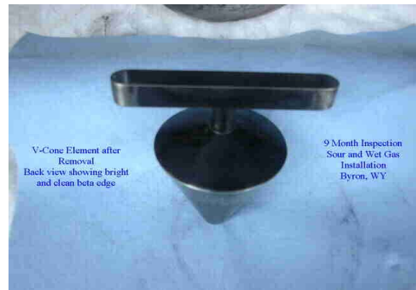
Figura 9. Vcone após 9 meses de teste
