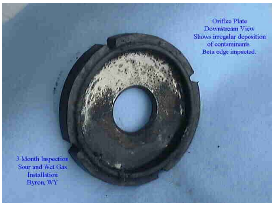
Figura 8. Placa após 3 meses de teste
